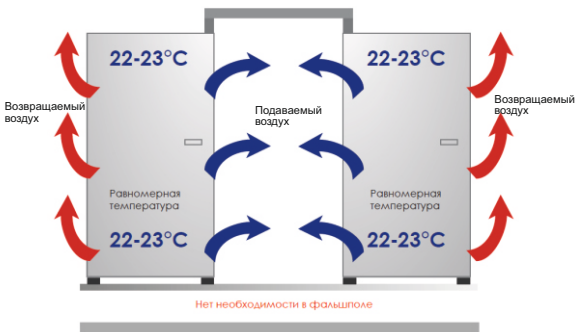
Рисунок 5 – Движение потоков воздуха при работе кондиционера
