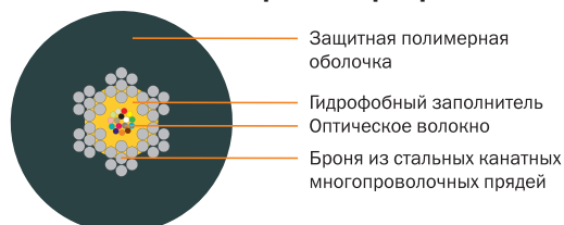
Вид кабеля в поперечном разрезе
