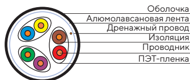
Вид кабеля в поперечном разрезе
