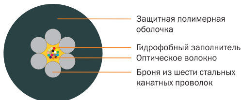
Вид кабеля в поперечном разрезе
